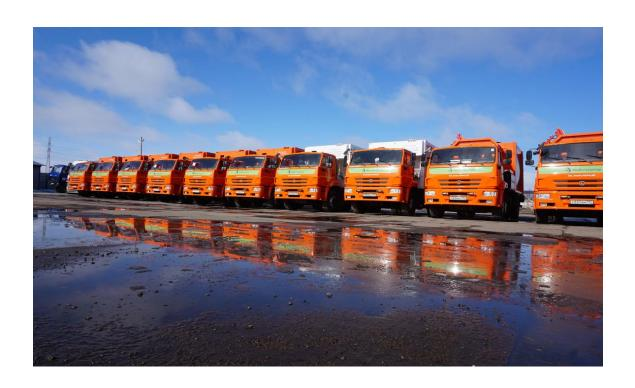
В Архангельск пришли 15 мусоровозов на базе КАМАЗ - 6 с боковой и 9 задней загрузкой, - а также ломовоз с гидроманипулятором для вывоза крупногабаритных отходов. Перевозчик заявляет, что качество уборки контейнерных площадок улучшится. Современные машины могут вывозить на 30% мусора больше, в отличии от старой техники.
